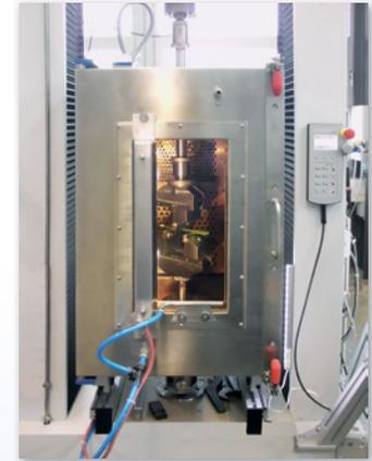
**Temperaturkammer:** Temperaturbereich von -70 °C bis +300 °C
