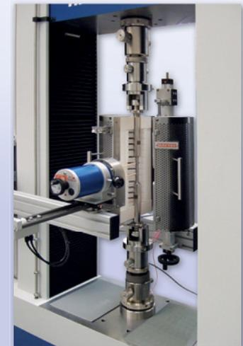
Aufklappbare **HT-Öfen** werden zur Werkstoff-Prüfung unter Hochtemperatur eingesetzt.
