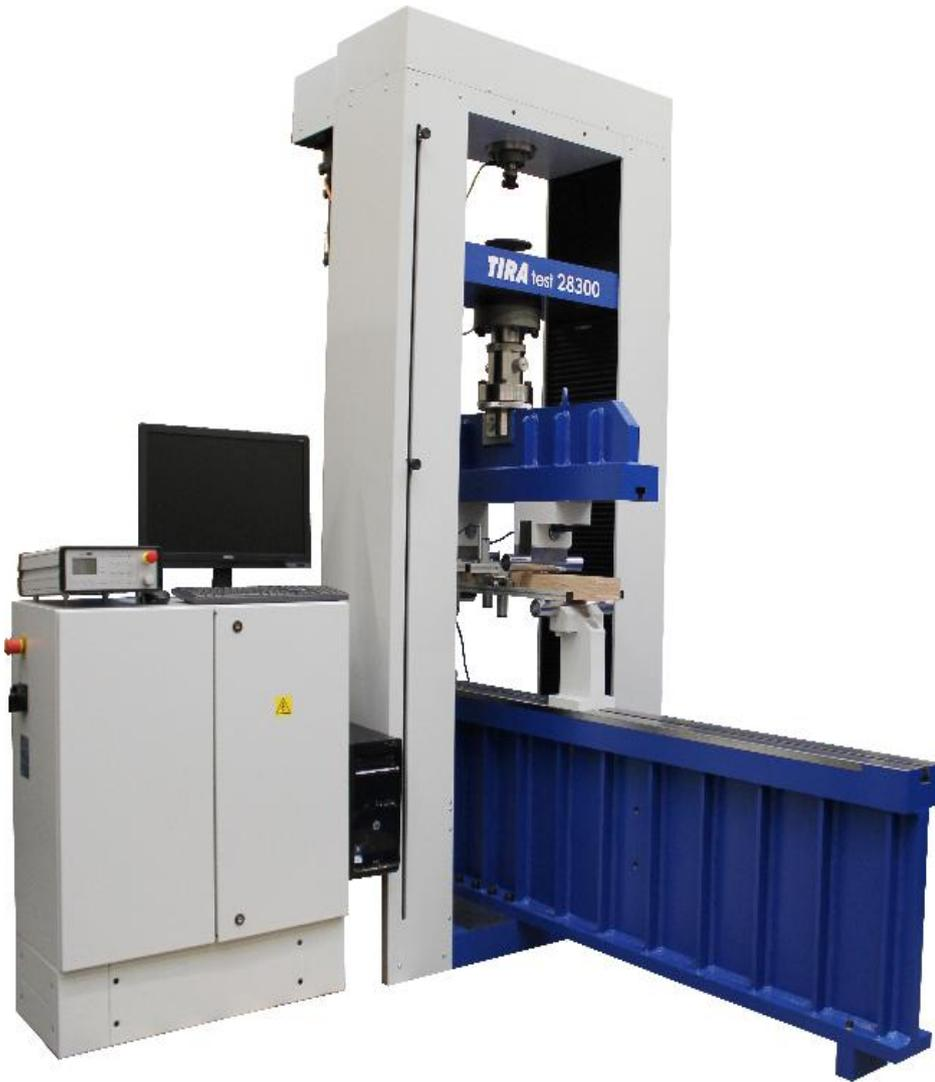
**Universell einsetzbare Festigkeitsprüfmaschine nach DIN 51220 und EN ISO 7500-1 für Zug-, Druck- und Biegeversuche für Forschung, Qualitätssicherung und Ausbildung.**
